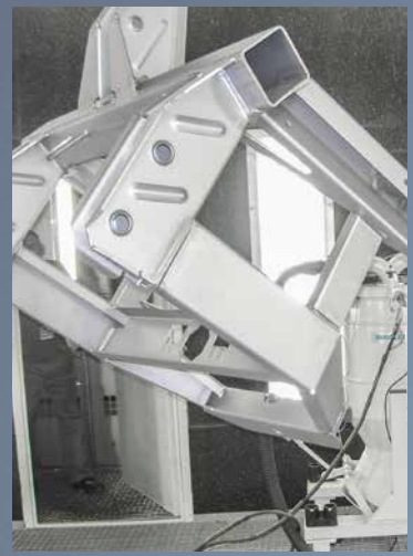
grenailé + testé! propre + exempt de graisse
