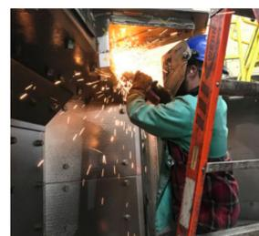
Recondicionamento e revisão de máquinas de jateamento
